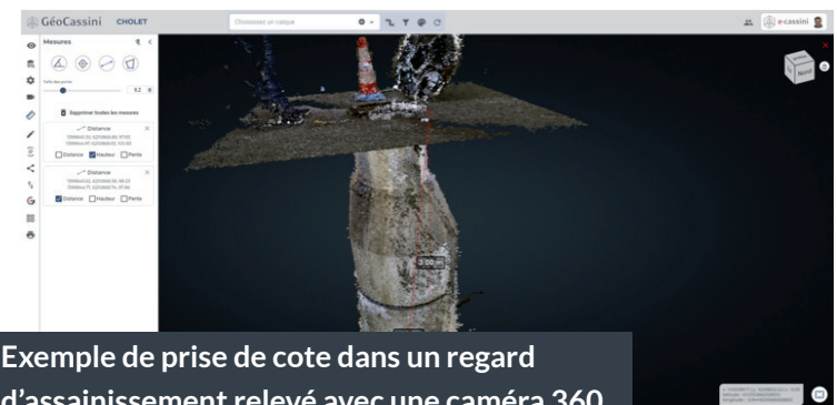
Récolement avec RezoCassini d'un regard d'assainissement.
