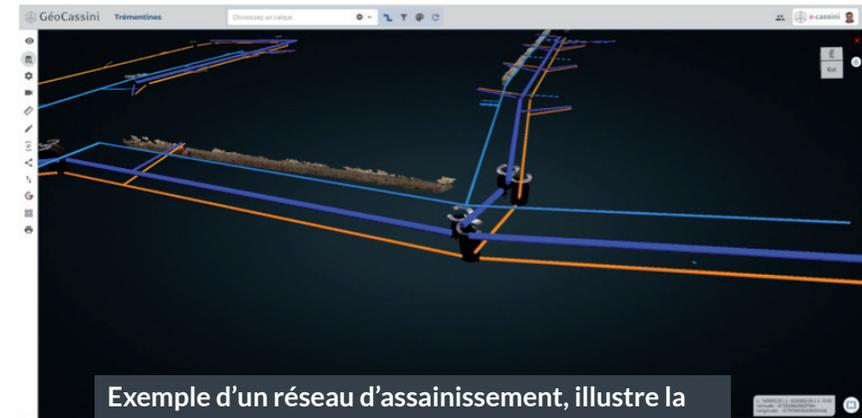
Exemple d'un réseau d'assainissement, illustre la visualisation de plusieurs réseaux en 3D
