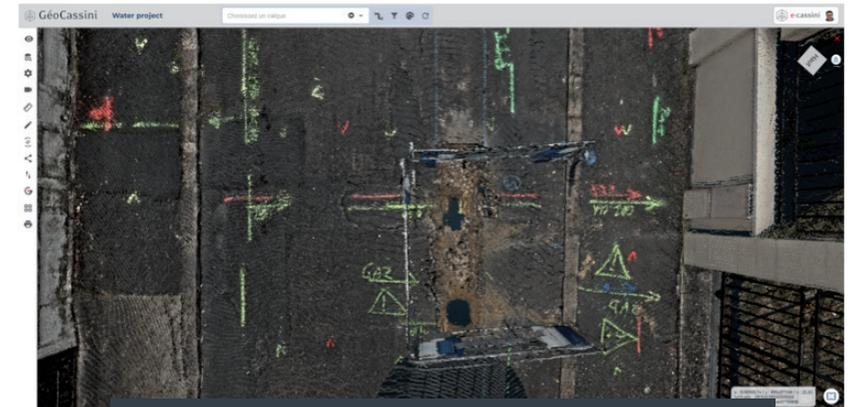
Exemple de transformation de vidéo après détection des réseaux en nuage de points
